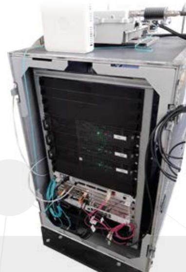
**Für die Speicherung und den Austausch von Daten zwischen den Baumaschinen wurde eine zuverlässige lokale Cloud-Lösung entwickelt.**
